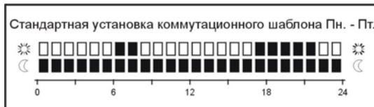
Автоматический режим можно менять посредством изменений в коммутационном шаблоне, переключатель вида режима установите в положение .
