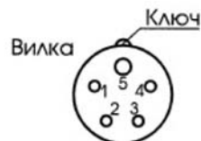
1, 2, 3 – фазы L1, L2, L3; 4 – N; 5 – заземление PE.
